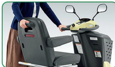
シート背面のクラッチハンドルで、手押しと電動走行の切替えがカンタンにできます。
