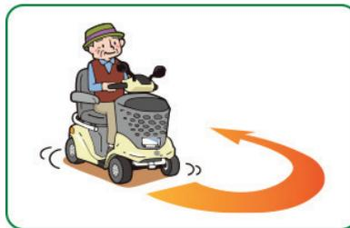
時速4.5kmを超える速度で走行する場合、ハンドルを切った角度に応じて自動的に時速4.5kmまで減速します。
